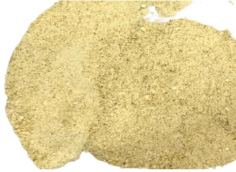
**Figura 3.** Suco misto em pó: resultado da secagem em leito de espuma.
